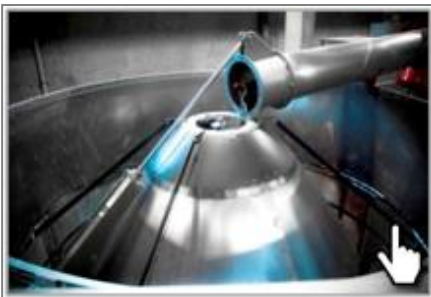
Центральный шнек из стали Hardox
