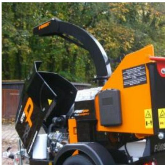
Greenmech в современных моделях использует трубу круглого сечения. Круг имеет меньшую площадь ребер, чем квадрат, что также сокращает и трение. Ну и нет мест скопления опилок или зеленой массы.
