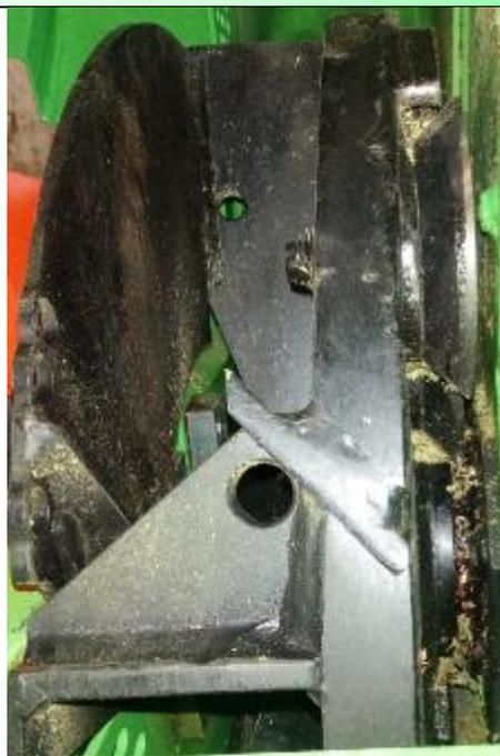
Плоскость расположения ножей не изменяет зазор (между контрножом) со временем износа. То есть независимо от изношенности ножей резка будет происходить также, как и с новым комплектом.
