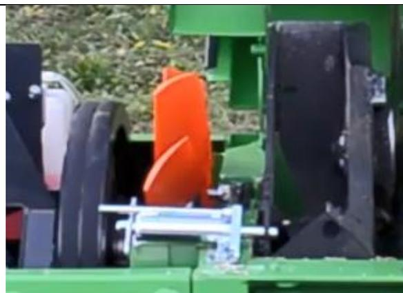
Все измельчители Greenmech штатно оборудованы системой запираения ротора для проведения работ с ножами. Безопасность прежде всего
