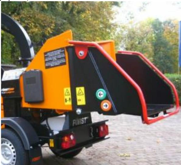
Greenmech комплектует свои измельчители усовершенствованными входными столами. Так, например, Arborist 150 имеет честную ширину 970 мм, что облегчает труд операторов. И в этом прикладное отличие.
