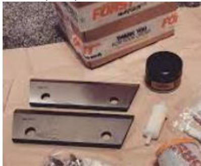
Нож устанавливается под углом к ротору, а для увеличения продолжительности жизни ножа его кромка затачивается под углом 40°. Но далее (основная часть) затачивается под углом 25°. Таким образом, время заточки ножа возрастает, и требует более внимательного отношения от слесаря. Так как необходимо следить за несколькими параметрами.
