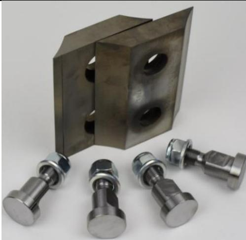
Timberwolf используют ножи с так называемой «полой» заточкой. Название подразумевается из-за формы выборки материала. Таким образом заточенный нож имеет режущую часть, схожую со скарификатором. Эта форма хорошо проникает в структуру древесины и откалывает её. Ножи закалены на всю глубину, и имеют высокое значение твердости. Кстати, о закалке ножей на всю глубину есть указание на официальном сайте производителя. Кроме того, ножи сейчас на все модели двусторонние. А теперь по порядку.
