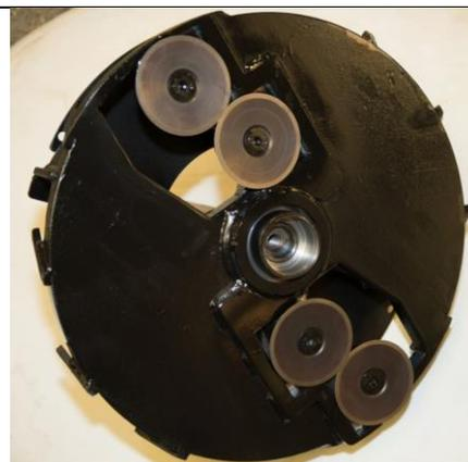
Радиально расположенные на роторе направляющие эффективно очищают рубильный объем от любых налипающих или расклинивающихся веток и смолы. Даже при работе с елью, туйей и даже пальмами – ротор очищается самостоятельно. Не требуется приостанавливать работу и для периодических прочисток если после последней ветки сразу заглушить мотор.
