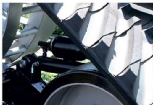
Азотный гидронатяжитель с амортизатором SHOCK ABSORBER обеспечивает автоматическое натяжение резинового трака
